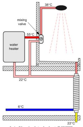
Figure 2-1: Vertical (tubular) DWHR system
